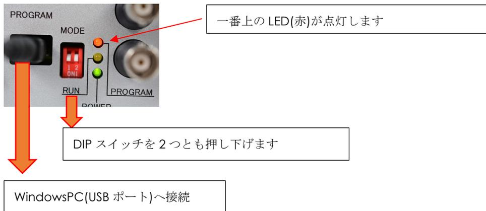
Windows 側は、本製品を仮想シリアルポートとして認識します。デバイスマネージャー等を使い、本製品が接続された COM ポート番号を調査します。以下の場合、Silicon Labs CP210x USB to UART Bridge(COM11)が本製品ですので COM11 となります。
