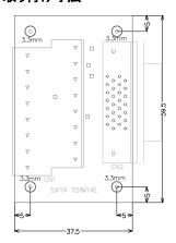
3.3mm 取り付け穴は全てFGです。 (グラウンドに接続されている)
